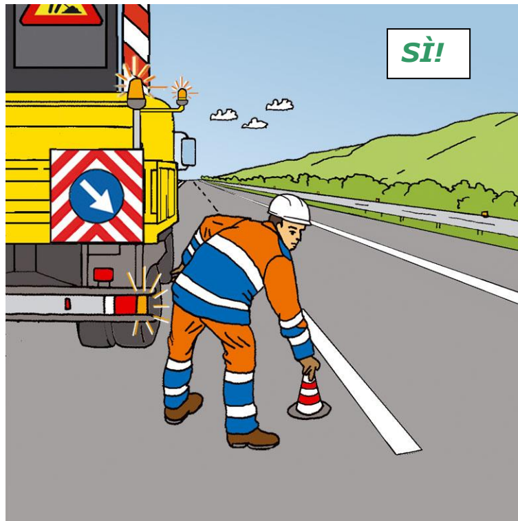
Figura 58 – Posizionamento dei coni o defleco: comportamento corretto
