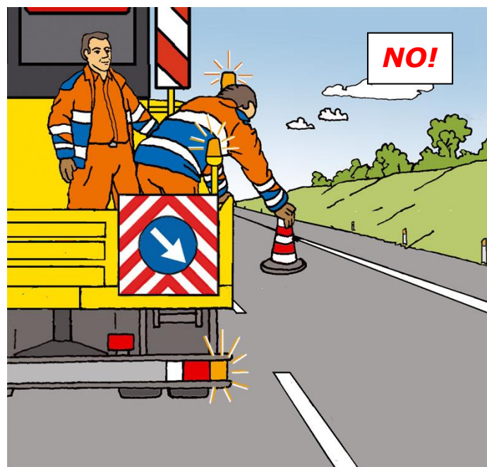
Figura 59 – Posizionamento dei coni o defleco: comportamento scorretto
